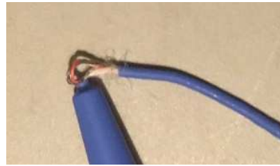
Fig. 2: Cobertura de protección dañada por una tracción excesiva del cable.
