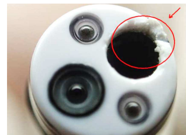
Fig. 4: Cabezal de endoscopio manipulado incorrectamente
